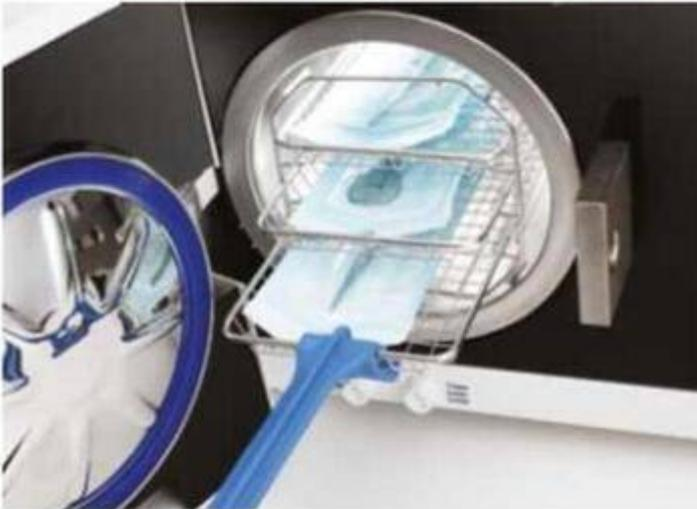
Apparecchiatura valida per la sterilizzazione di attrezzature ad uso estetico.
